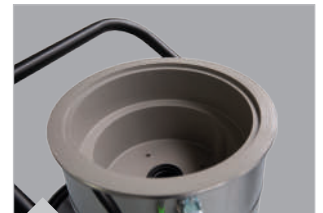
Inserção de proteção com boia integrada evita que o líquido penetre nos filtros ou nos motores de sucção durante a aspiração de líquidos
