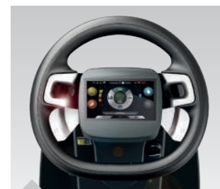
Volante “PLUS” com ecrã touch e patilhas para controlar a pressão e marcha-atrás
