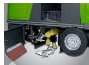
Escovas substituíveis sem necessidade de ferramentas
