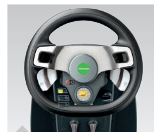
Volante “BASIC” com pequeno ecrã e patilhas para controlar a pressão e marcha-atrás
